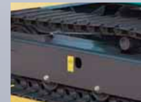
泥落ちのよい片流れクローラフレーム。
