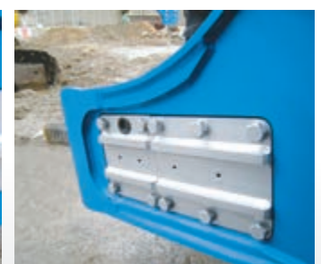
▲ メンテナンスがしやすい大きな点検口 (S-100B以上)
