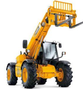
7m Boom 3t Payload
